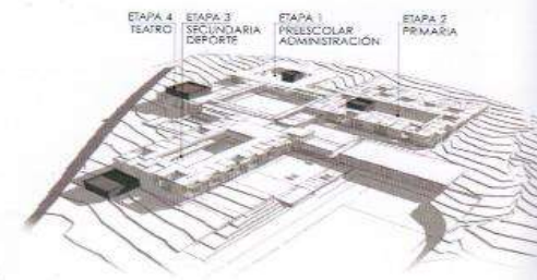
ETAPAS DE CONSTRUCCIÓN
